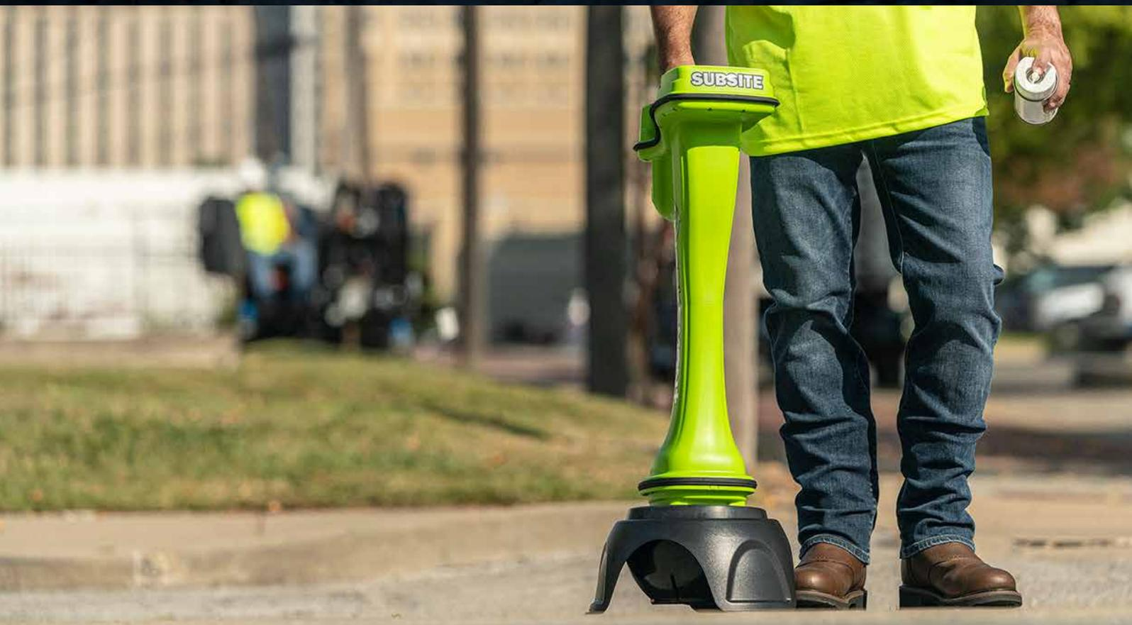
**Das Subsite® Marksman HDD Ortungssystem bietet überlegene Leistung in Umgebungen mit hohen Interferenzen mit dem branchenweit grössten Frequenzbereich in einer einzigen Sonde.**
