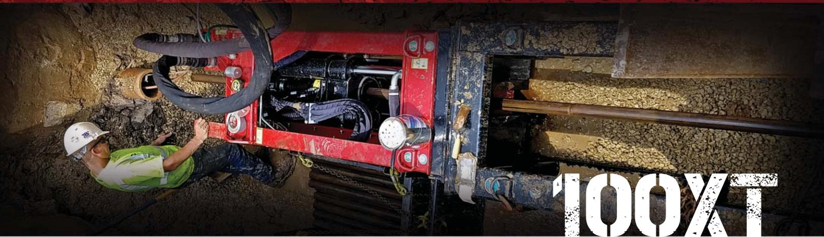
**AUTOMAT ROD SPINNER.** Das innovative Rod Spinner System kann die nächste Stange während dem Stoss- oder Zugvorgang an- und abkupplern. Somit wird die Zug- und Stossgeschwindigkeit massiv erhöht. Eine Klemmvorrichtung hält die Stangen zudem immer unter Zug und verhindert somit das Rückprallen der Stangen.
