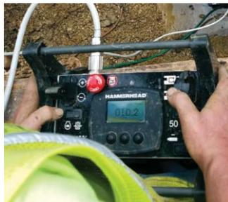
**DOPPELT SO SCHNELL.** Bei durchschnittlichen Bodenverhältnissen dauert eine Arbeit von 120m etwas mehr als 2 Stunden. Wenn es die Situation erlaubt und keine 100to benötigt werden, kann auf den 50to Modus gewechselt werden um mit einer doppelt so schnellen Arbeitsgeschwindigkeit des Hydrauliksystems zu bersten.
