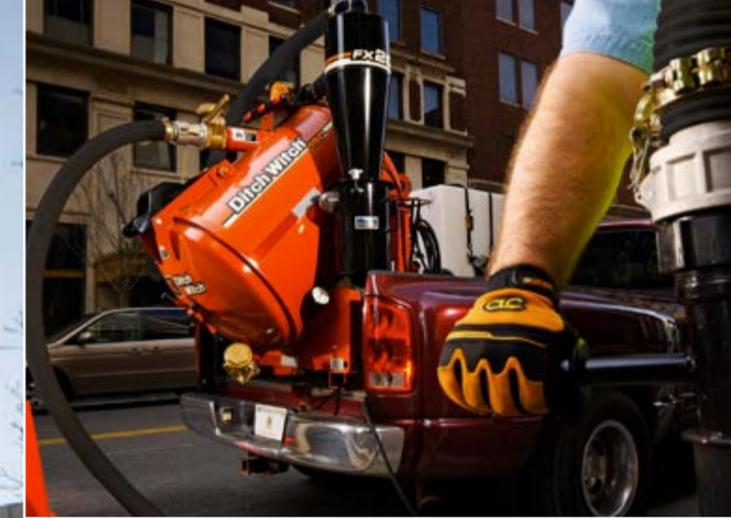
Der 20,1-kW-Sauger **Ditch Witch FX20®** ist ideal für eine Vielzahl von Baustellen und mehreren kurzen Einsätzen pro Tag: Kommunalarbeiten wie die Reinigung von Schlüsselhydranten, Schuttbeseitigung und Landschaftsgestaltung im Gewerbe- und Wohnbereich, Freilegung von Kabeln und Rohren, Erdbohrungen und viele andere Aufgaben. Wir haben seine Größe begrenzt, damit Sie ihn auf der Ladefläche Ihres LKWs problemlos transportieren können und hat trotzdem eine hervorragende Saugleistung.
