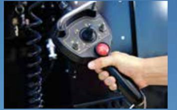
2 Die bewährte Fernbedienung ermöglicht ein exaktes Platzieren der Maschine, sowie ein sicheres Auf- bzw. Entladen der Bohranlage.
