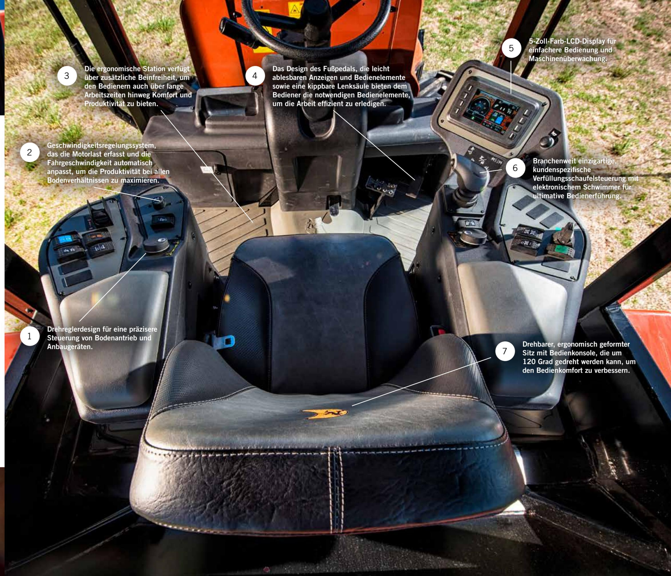
3 Die ergonomische Station verfügt über zusätzliche Beinfreiheit, um den Bedienern auch über lange Arbeitszeiten hinweg Komfort und Produktivität zu bieten.
