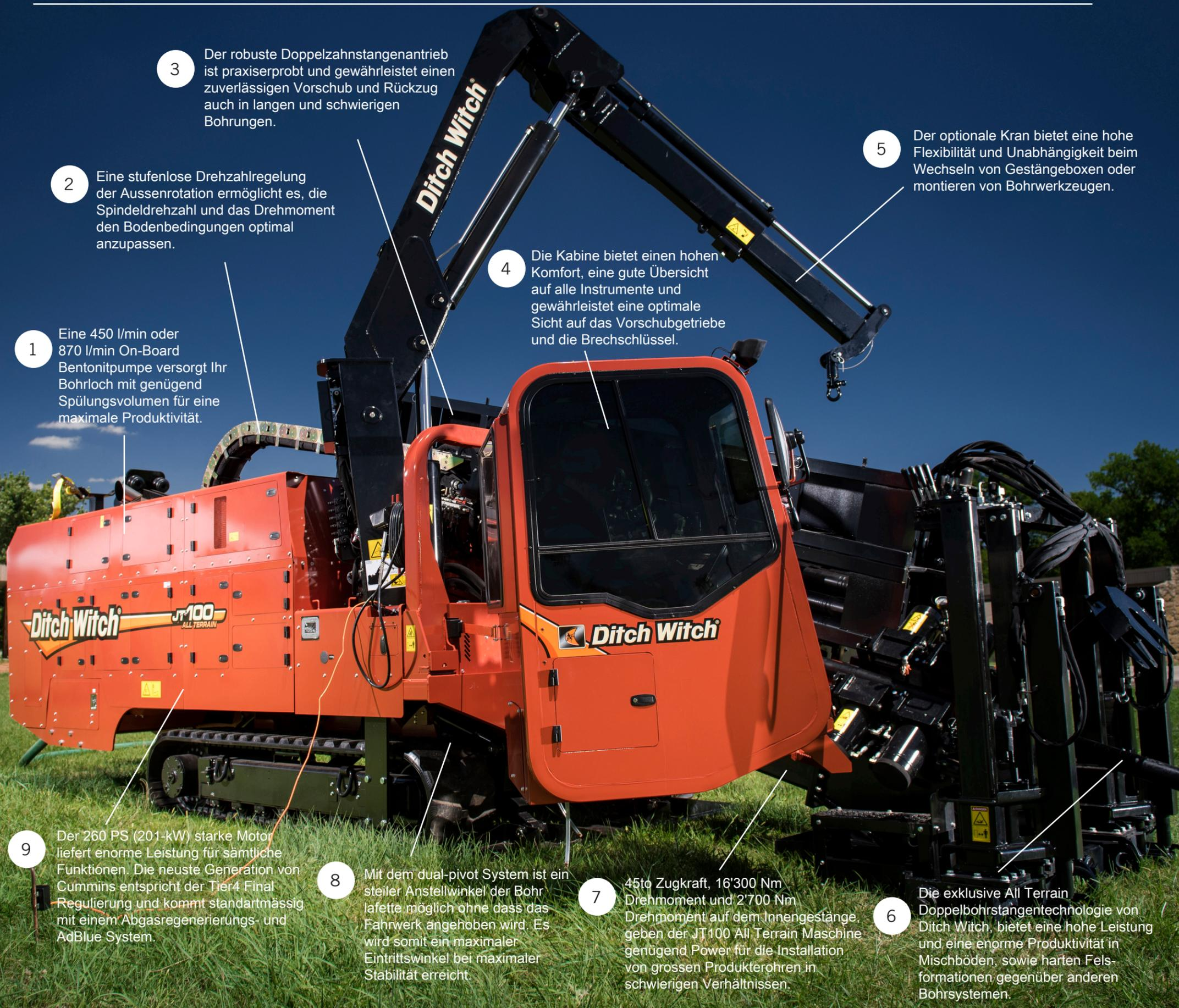
3 Der robuste Doppelzahnstangenantrieb ist praxiserprobt und gewährleistet einen zuverlässigen Vorschub und Rückzug auch in langen und schwierigen Bohrungen.
